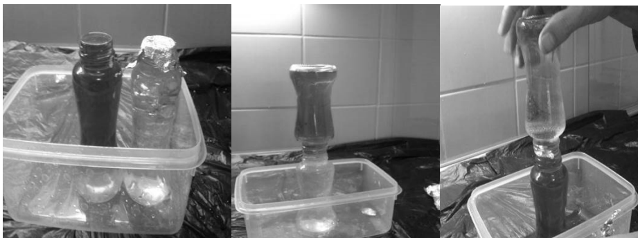
СЛИКА 5 а) боцице с топлом(црвено) и хладном водом (прекривена алуминијумском фолијом, б) боцица с топлем над оном са хладном водом, в) боцица с хладном над боцицом топлем водом
