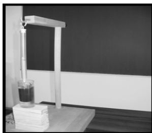
СЛИКА 7. Наставна средства потребна за доказивање Архимедовог закона
