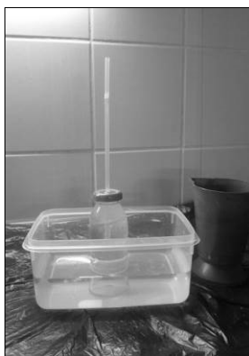
СЛИКА 4. Поставка експеримента за приказ ширења воде при загревању
