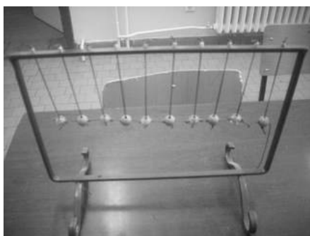
СЛИКЕ 6. и 7. Сталци за демонстрацију осциловања честица средине при таласном кетању
