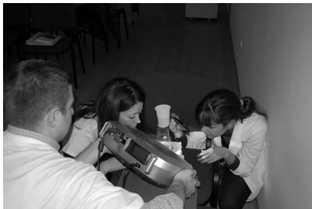
СЛИКА 2. Посматрање природног зрачења помоћу самостално направљене маглене коморе.
